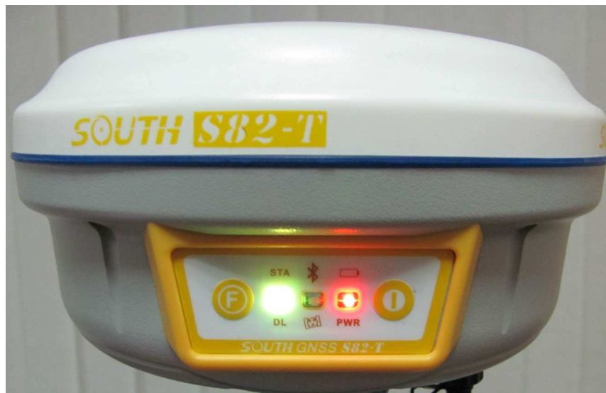
Рисунок 3.1 – Внешний вид передней панели S82-T
