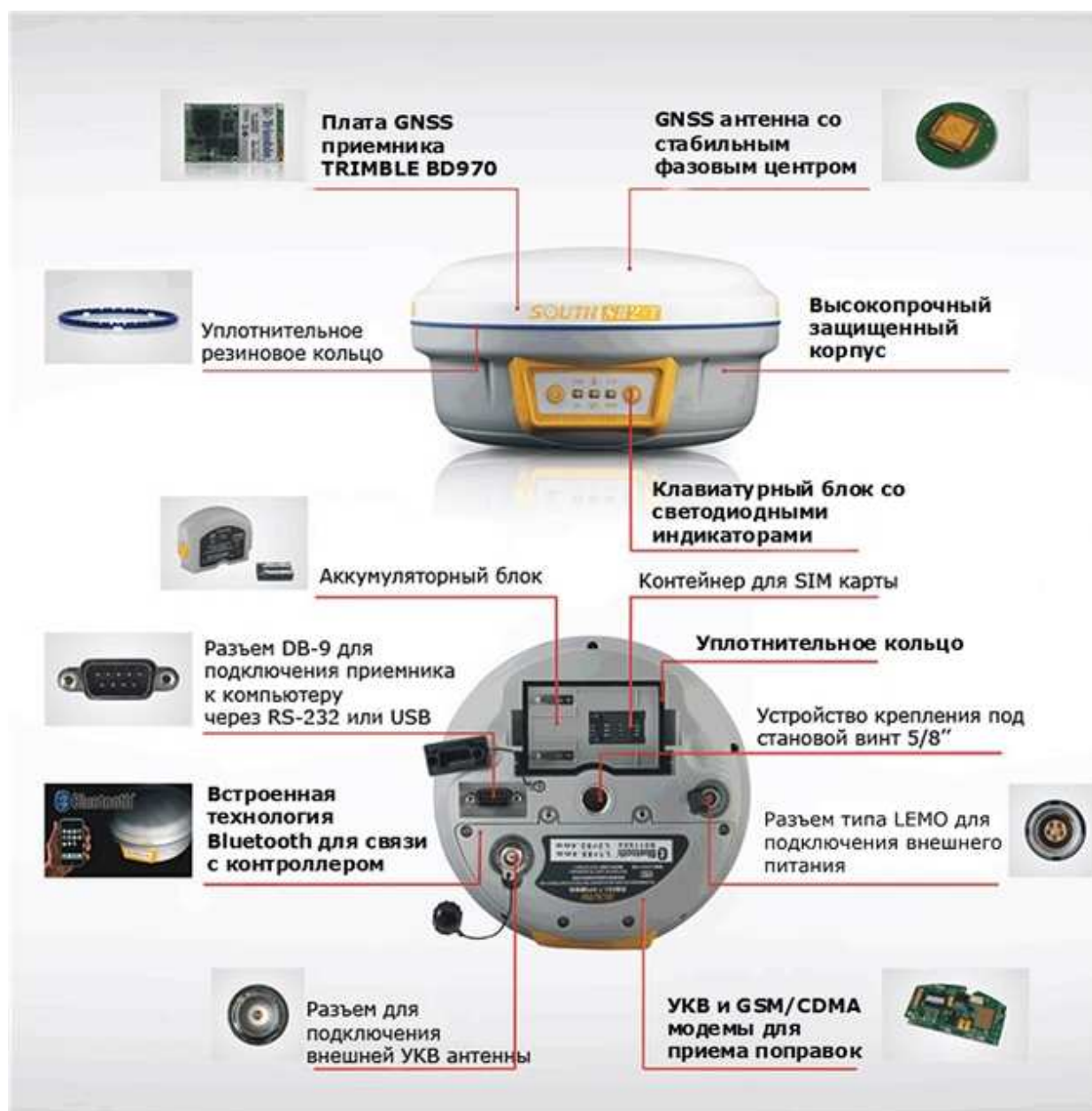
Рисунок 2.1 Общий вид и компоновка составляющих S82T
