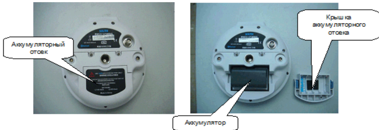
Рисунок 2.4 – Установка аккумулятора в S82T
