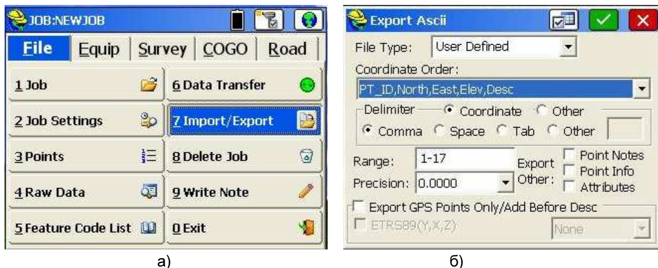
Рисунок 2.35 Преобразование координат точек работы в требуемый формат
