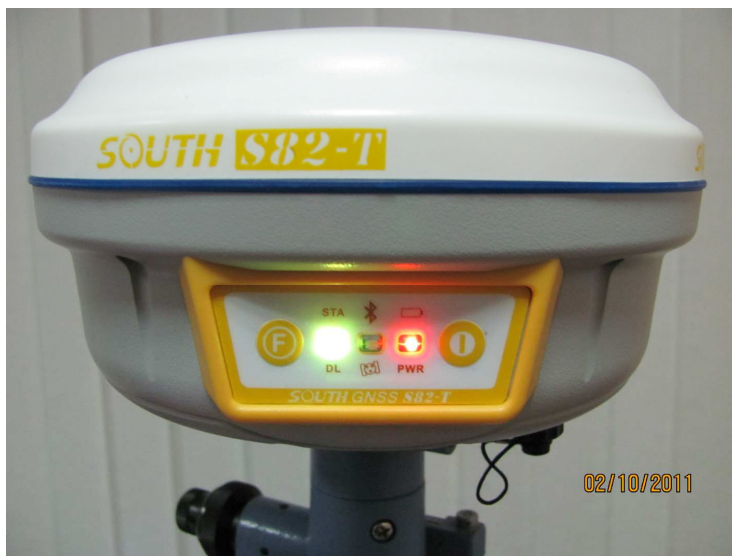
Рисунок 2.2 – Внешний вид основного блока S82T
